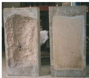
Fig. 13. Një pamje e OC (majtas - pëlçitje shpërthyesë) dhe PPFRC (djathtas) pasi ekspozohet në temperatura të ngritura
