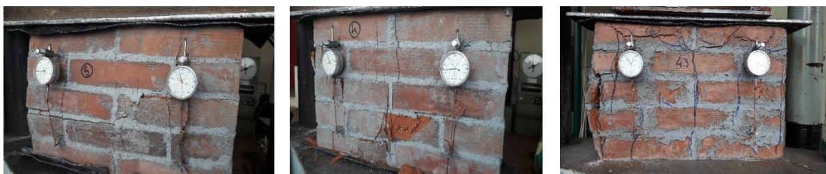
Слика 8: Состојба на лом на испитаните примероци
