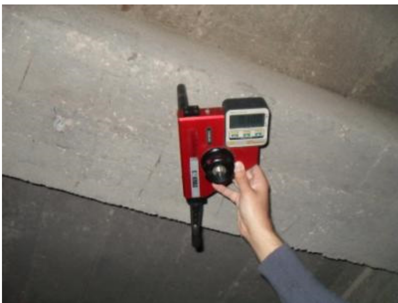
Сл. 7. Испитување на атхезиона врска помеѓу бетон и арматура
