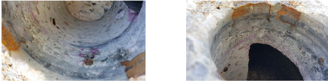
Сл. 7. Контрола на карбонизација на пресекот
