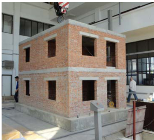
Сл. 4. Лабораториски модел на сидана конструкција (Shendova, 2013)
