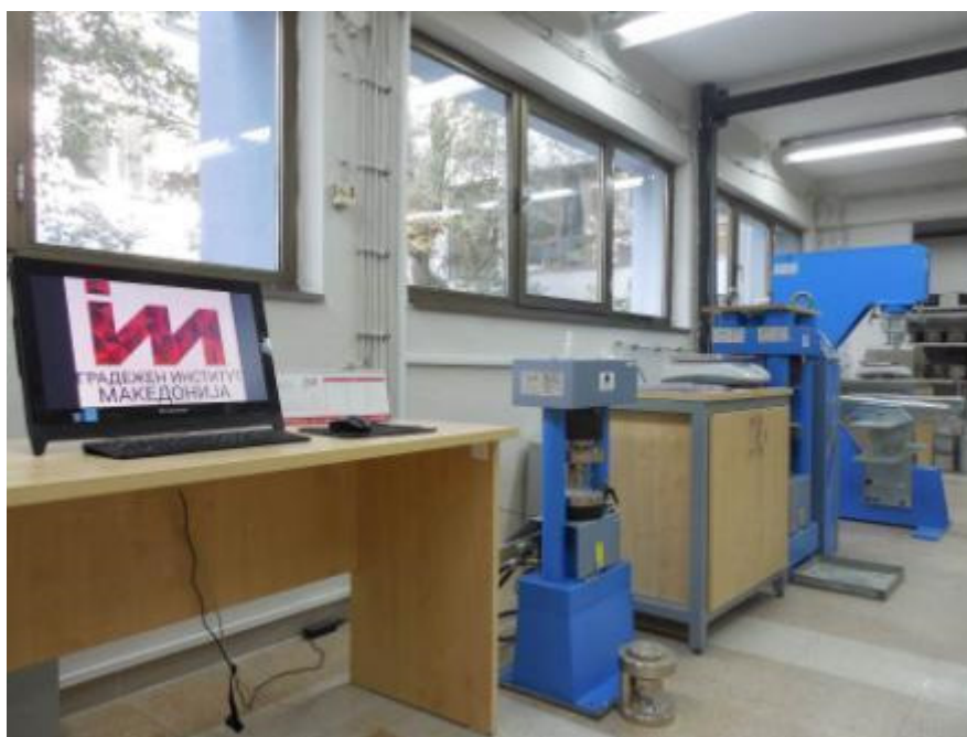
Сл. 3. Преса за испитување на контролни примероци
