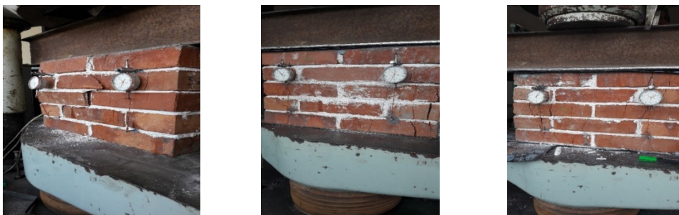
Слика 6: Состојба на лом на испитаните примероци
