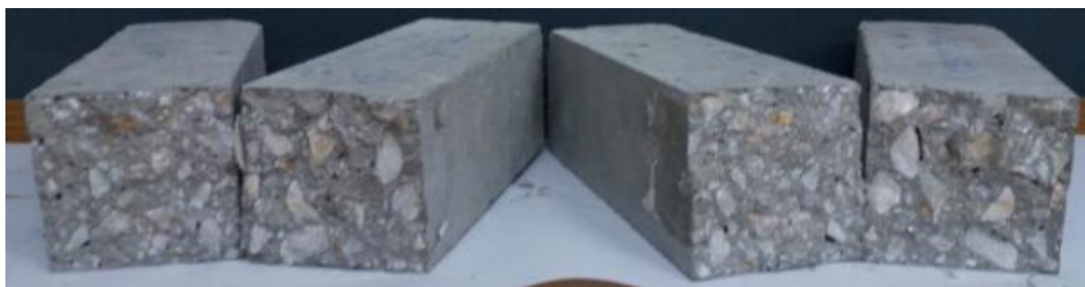
Сл. 8. Изглед на контролни тела по испитување на јакост на свиткување
