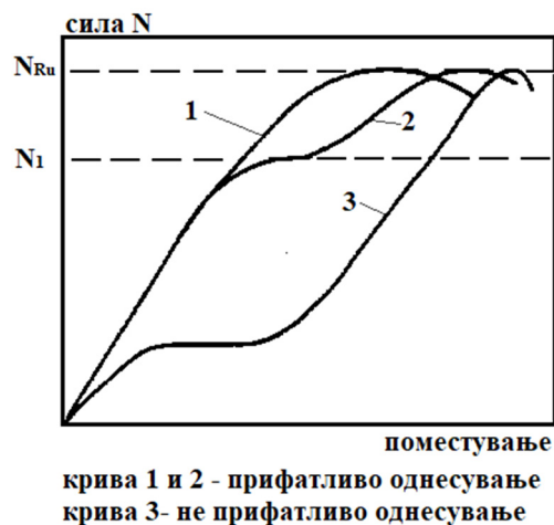
Слика 5. Очекувани криви на однесување на анкерите
