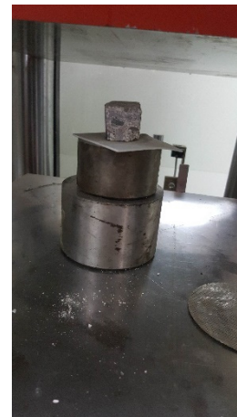
Сл. 6. Испитување на јакост на притисок
