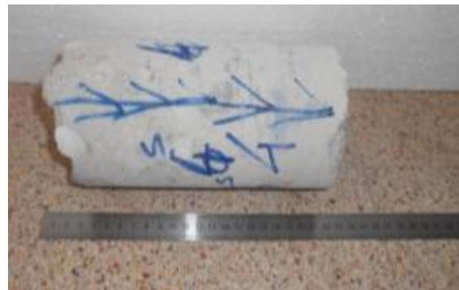
Сл. 9. Изглед на бетонско јадро од опожарен објект
