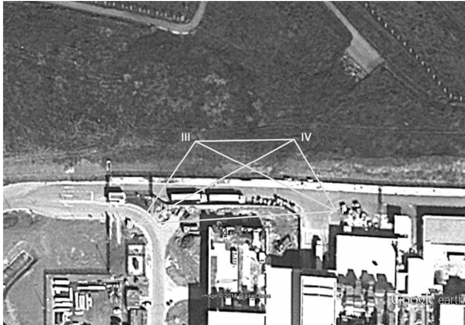
Сл. 2. Распоред на геодетската мрежа за деформациските мерења на оџаците
