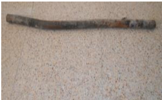
Сл. 8. Изглед на извадена арматурна прачка
