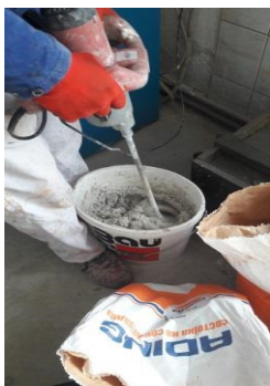
Слика 4: Апликација на материјалите и подготовка за pull-of тест
